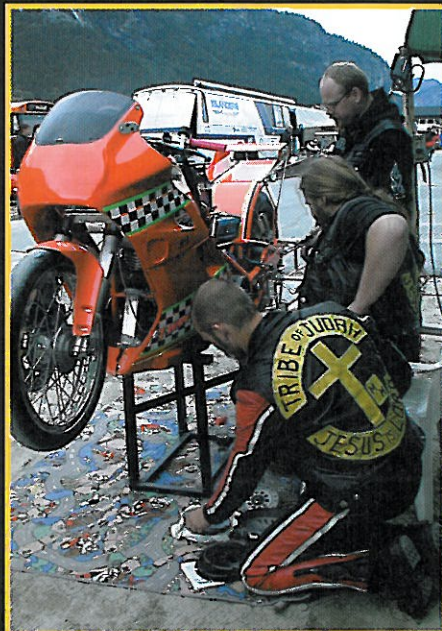
Testkjøring i Valle - clutchen holdt ikke godt nok. Imidlertid med nye lameller for neste runde.
