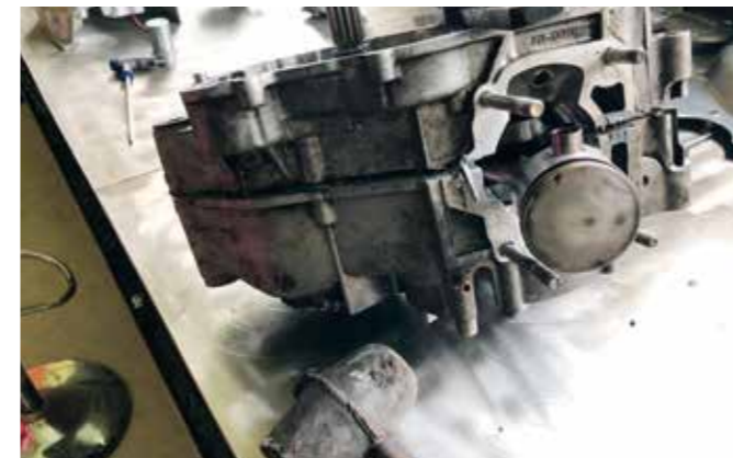
Slik ser veiven ut i frittforfjortilstand, veivlagre står i liggjenn i girkassehalvdeler. Lagrene må bli presset ut. Av og til følger disse lagrene med veiven ut, andre ganger ikke.
