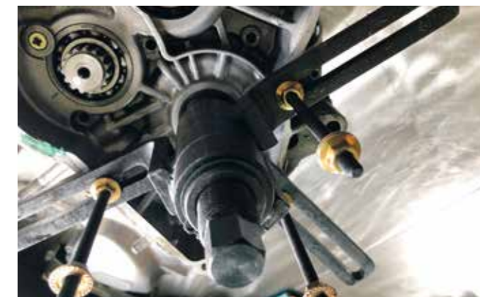
Tuskverktøy satt opp til å presse girkassehalvdeler fra hverandre.
