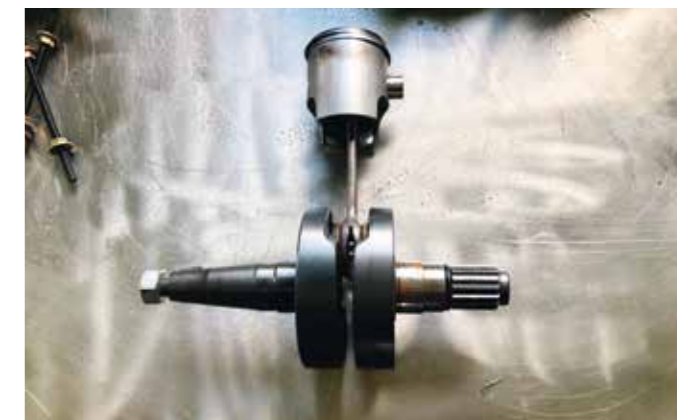
Slik ser veiven ut i frittforfjortilstand, veivlagre står i liggjenn i girkassehalvdeler. Lagrene må bli presset ut. Av og til følger disse lagrene med veiven ut, andre ganger ikke.
