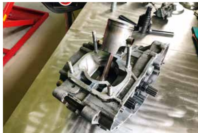
Motor klar for å bli splittet. Alt som kan fjernes på sidene er skrudd av. Kryssbolt i stempel sitter fast, og blir fjernet ut senere.
