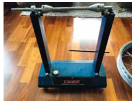
Jeg bruker oppheng fra Tusk til å rette opp felg, men det trenger ikke være så avansert. Her kan du bruke den originale hjulbolten og bruke for eksempel baksvingen på sykkel. Poenget er at det må være stødig uten mulighet for sideveis bevegelse.
