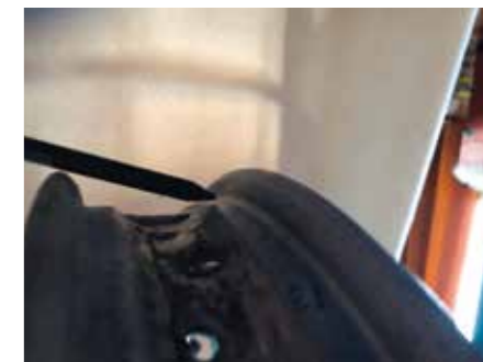
Det første som gjøres er å rette opp/ ned bevegelsen. På den halve omkretsen av felgbanen som har størst avstand til markør på spiler slakkes, den med minst avstand må spiler strammes. Jeg liker å gjøre justeringer med en omdreining om gangen. Markøren peker mot der dekket ligger. Er det kast på ikke mer enn ca tykkelsen av en fingernegl, er dette veldig bra.
