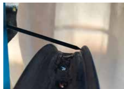
Når opp/ ned bevegelse er justert inn, er det sidebevegelse som må justeres. Jeg lar markøren ligge på innside av felgbane hvor dekket har anleggsflate. Skal en del av felgbanen til høyre, må først de spilene som drar mot venstre slakkes en omdreining, for de som drar til høyre strammes en omdreining i det aktuelle området.
