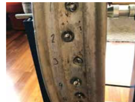
Ved å nummerere spiler, er det enklere å spenne opp felgen. Nå er spilene slakke, og jeg skrur inn spile 1 og 2, 19 og 20, 9 og 10, 29 og 30 noenlunde likt. Da blir felgbanen ganske greit sentrert, og resten av spilene kan strammes forsiktig.
